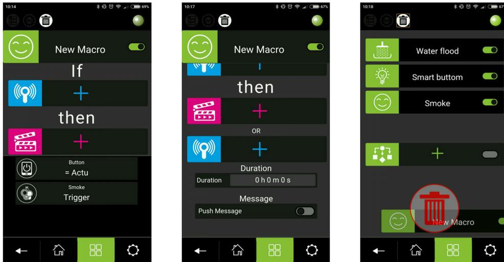
*В режиме Macros каждая сцена рассматривается как набор датчиков и "непоходящие" по мнению системы датчики под условие могут игнорироваться при выборе. Здесь следует понимать, что макросы рассчитаны на создание простых конструкций "если-то" и не рассчитаны на создание разветвленных сложных условий.*
